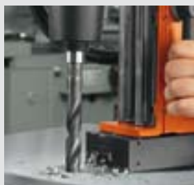
Spiralbohren mit Bohrfutter oder MK3-Aufnahme
