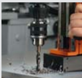
Spiralbohren mit Bohrfutter
