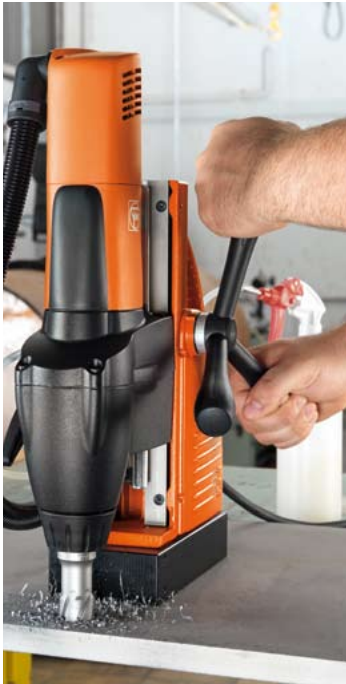
Die Innenkühlschmierung der FEIN Kernbohrereinheiten ermöglicht zügiges, wirtschaftliches Arbeiten und eine lange Werkzeugstandzeit.
