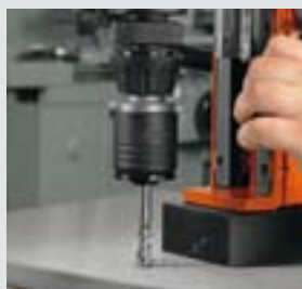
Gewindegängen mit Gewindegäng-Schnellwechselfutter
