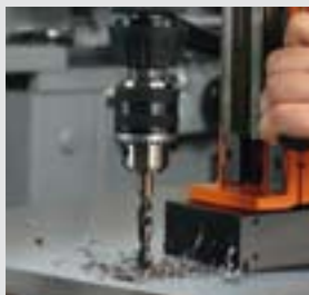
Spiralbohren mit Bohrfutter
