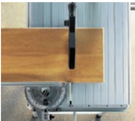
Kappschnitte sind mit der CS 70 schnell erledigt – bis 320 mm.
