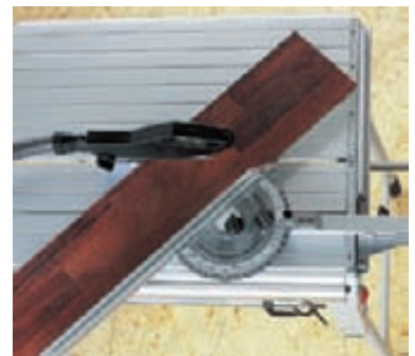
Auch Kappschnitte mit Winkeln von z. B. 45° sind mit Winkelanschlag und CS 70 kein Problem.
