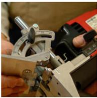
Einstellungen für Materialstärke, Schwenkansschlag und Bohrtiefe stufenlos möglich.
