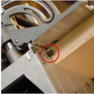
Versenkbare Anschlagstifte für randnahe Bohrungen ohne Anriss.
