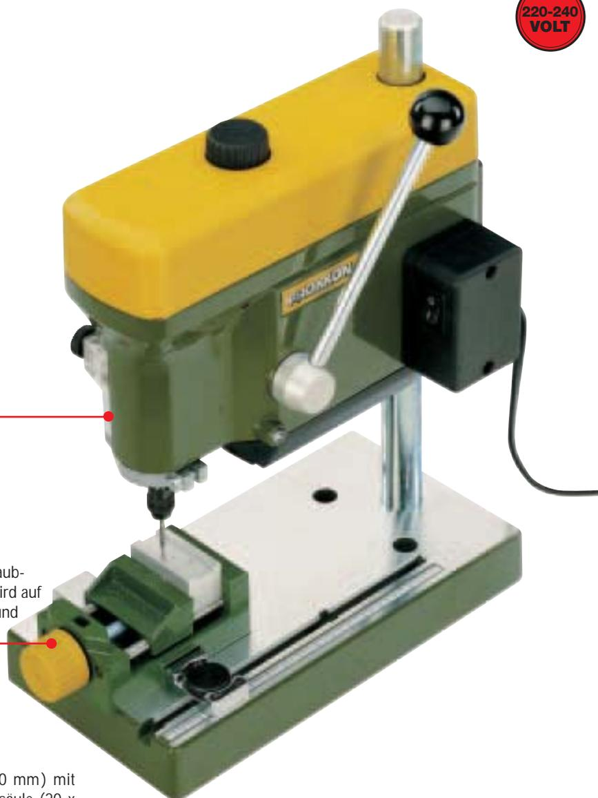
Plangefräser Arbeitstisch aus Alu-Druckguss (220 x 120 mm) mit Parallelanschlag und Skala. Massive, hartverchromte Stahlsäule (20 x 280 mm). Ausleger aus Alu-Druckguss mit ausgespindelten Führungen und Passungen. Hochwertiger, VDE-geprüfter E-Motor, extrem leise und sehr langlebig. Antrieb über 3-fach-Riemenscheibe. Durch Umlegen des Flachriemens ergeben sich 3 Leerlaufdrehzahlen bei mehr als 3-fachem Drehmoment im unteren Drehzahlbereich. Praktische Bohrtiefenanzeige mit einstellbarem Anschlag.
