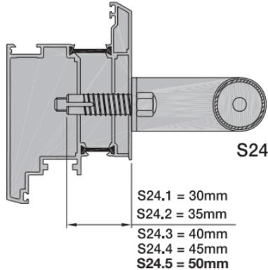
Stückbefestigung mit Selbstschneidehülse,
