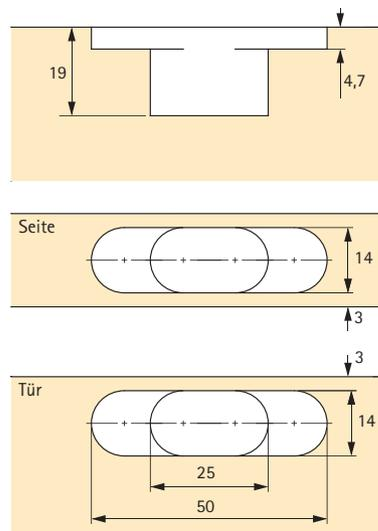
Befestigung mit Senkholzschraube  $\varnothing$  3 DIN 97
