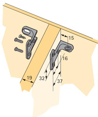
4 Mittelwandbefestigung mit Panhead  $\varnothing$  4 x 12 mm
