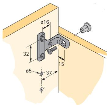
2 Stumpf aufliegende Rückwand (min. 16 mm), Befestigung mit Linsenschraube M6 x 12 (DIN 7985) mit Gewindekappe M6
