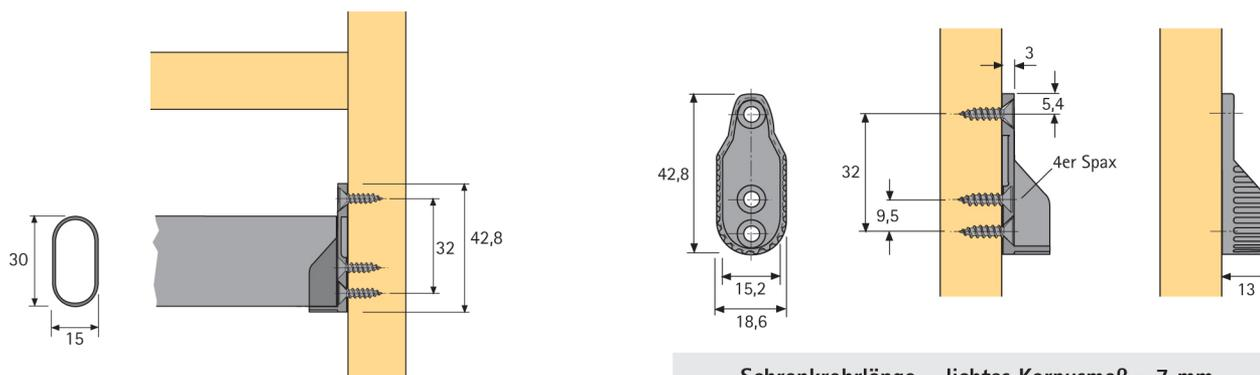
Schrankschrankrohrlänge = lichtetes Korpusmaß - 7 mm
