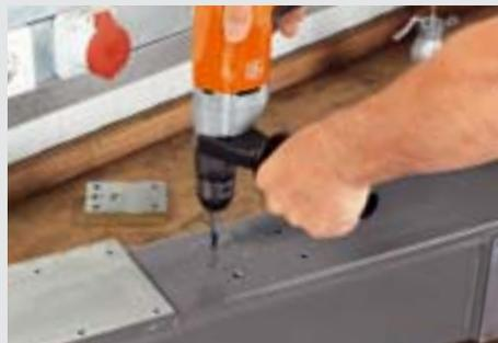
Leistungsintensive Arbeiten wie Gewindeschneiden können durch das beständig hohe Energieniveau zuverlässig ausgeführt werden.
