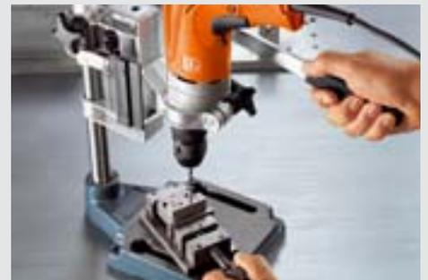
Durch den genormten Euro-Spannhals lassen sich alle BOP-Bohrmaschinen auch stationär einsetzen.
