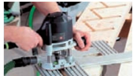
Treppenwangen können durch die Verlängerungsprofile passgenau abgebildet werden.
