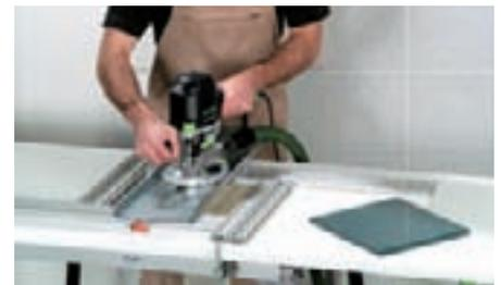
Flächige Ausfräsungen können einfach und sauber mit dem Frässchlitten MFS-FS erledigt werden.
