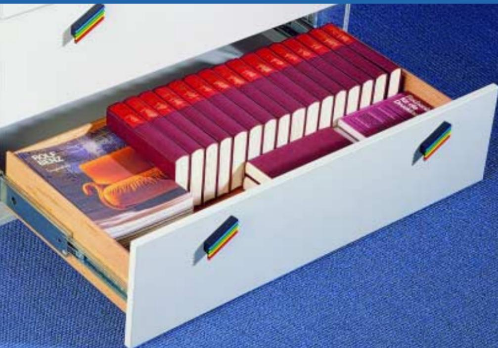
Kugelauszüge sind wegen ihrer guten Laufeigenschaften, der schnellen Montage und geringen Einbaubreite beliebt. Sie eignen sich für die **Seitenwandmontage**, die **Aufsteckmontage** und für Schubkästen mit **Nutmontage** bei 17 bzw. 27 mm Nuthöhe.
